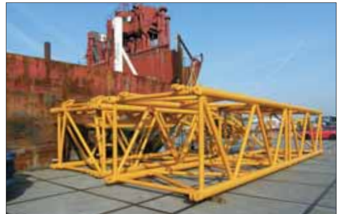
Giekdelen en tuistangen van een 450 tonner, lengte 12 m.
