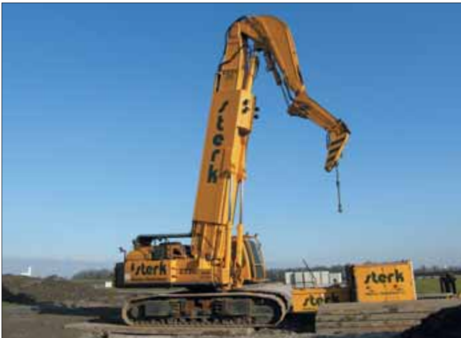
Een mooi voorbeeld van een volledig hydraulische kraan: de Etec 880 van Sterk Heiwerken. Deze machine wordt gebruikt voor het plaatsen van damwanden.
