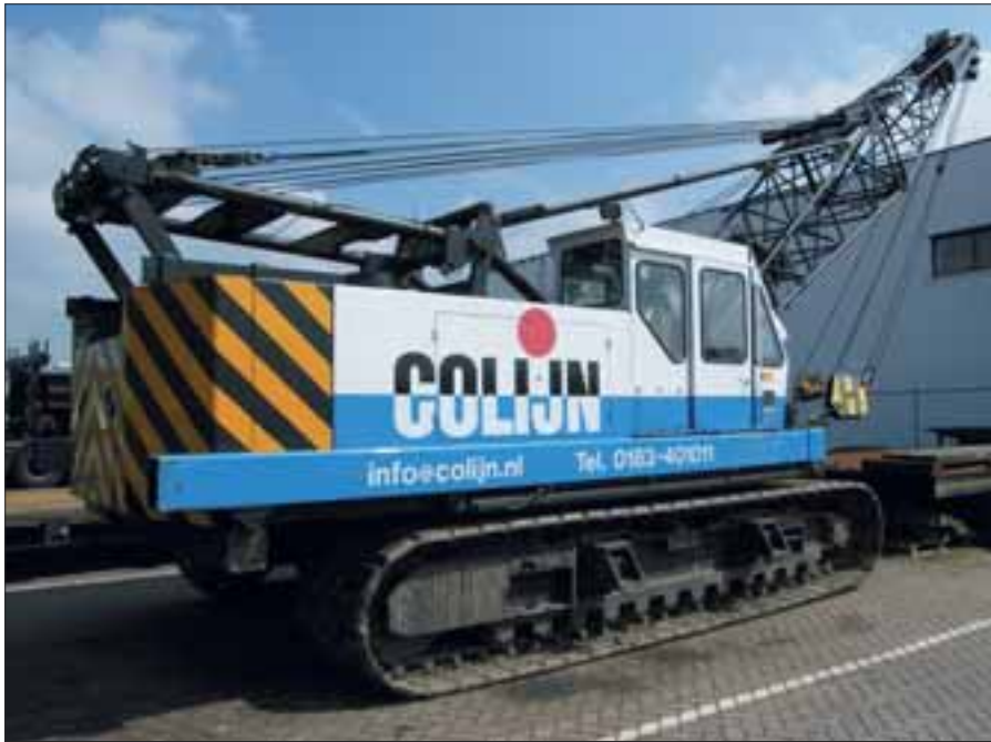
Hitachi KH150 met basisgiek en A-frame in transportstand).
