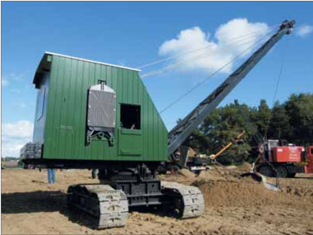
Priestman Cub met constructiegiek en houten bekleding van de bovenwagen.
