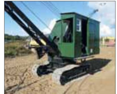
Priestman Cub met constructiegiek en houten bekleding van de bovenwagen.
